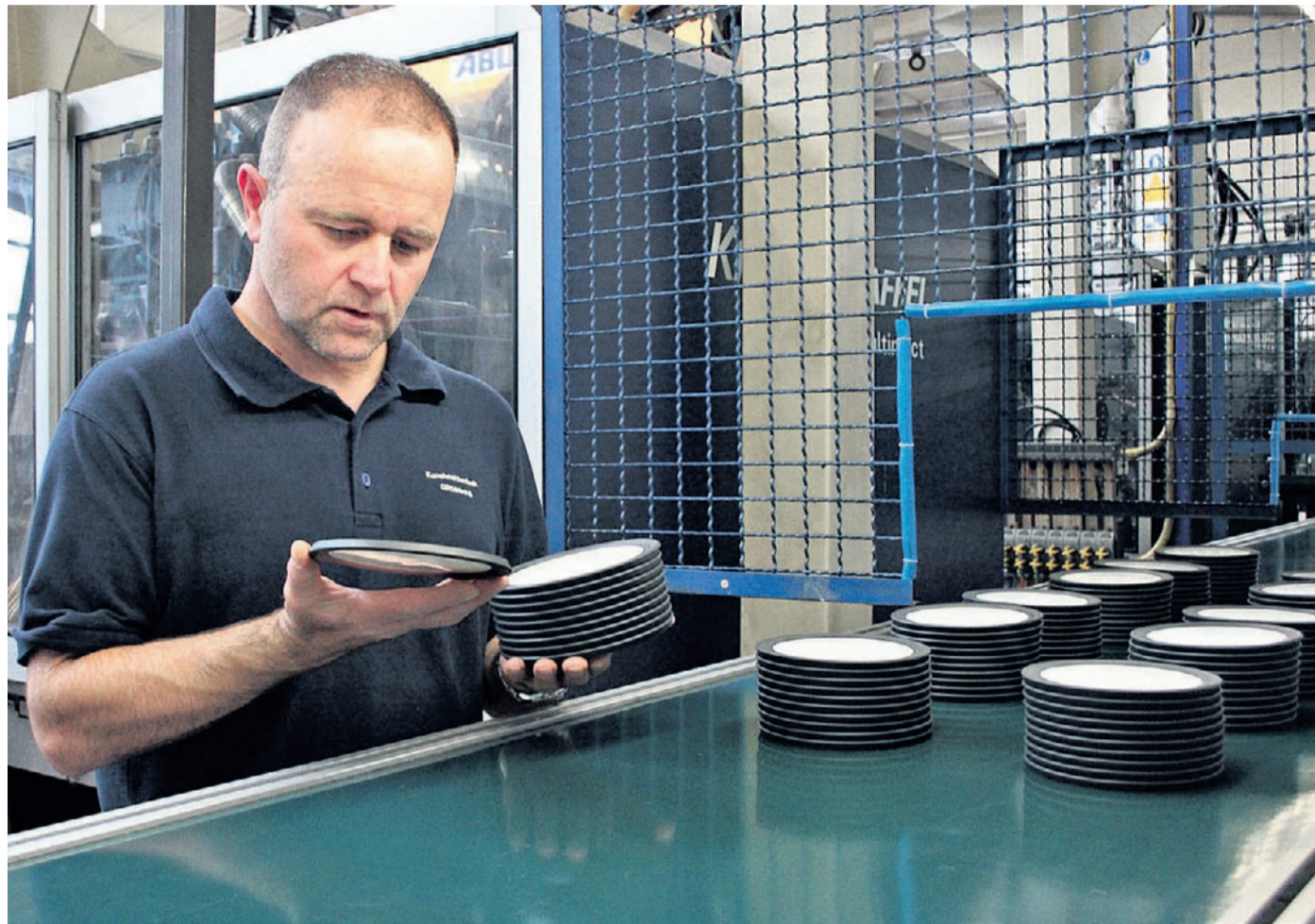
Rainer Stahl, der Leiter der Qualitätssicherung, kontrolliert die Verschlussdeckel für Mixgeräte der Firma Braun, die in Wangershausen hergestellt werden. Sie bestehen aus Zwei-Komponenten-Kunststoff.
